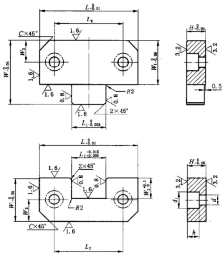
未注表面粗糙度  $R_a=6.3 \mu\text{m}$ ；未注倒角  $1 \text{ mm} \times 45^\circ$ 。
